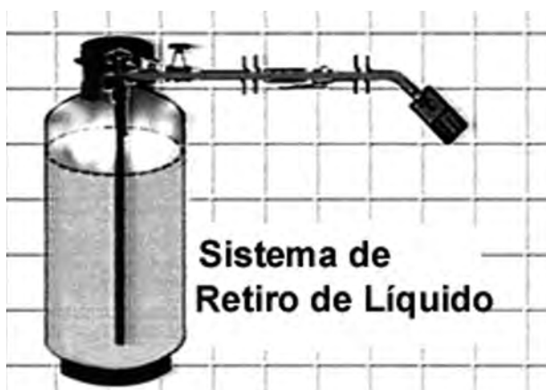
Figura 5: El combustible líquido es jalado desde el fondo del tanque.
