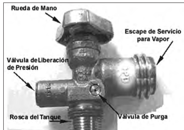
Foto 3: Muestra una válvula OPD de cilindro
