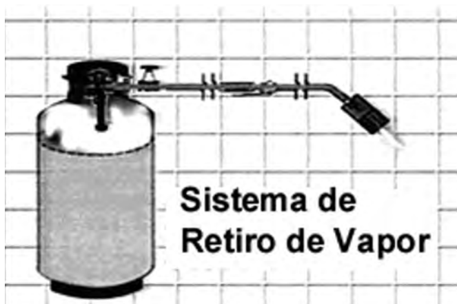
Figura 4: Muestra los vapores que se acumulan en la superficie superior del tanque.
